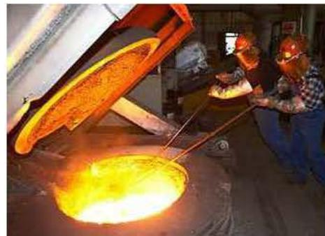
Рисунок 62. Плавка сплава в тигельной электропечи.
