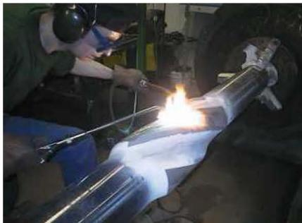
Рисунок 51. Метод газоплазменного напыления
