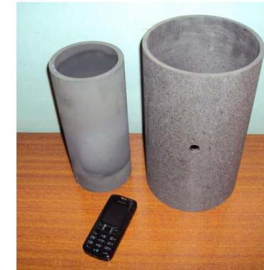
Рисунок 66. Компоненты нагревательных устройств из высокотемпературной металлокерамики
