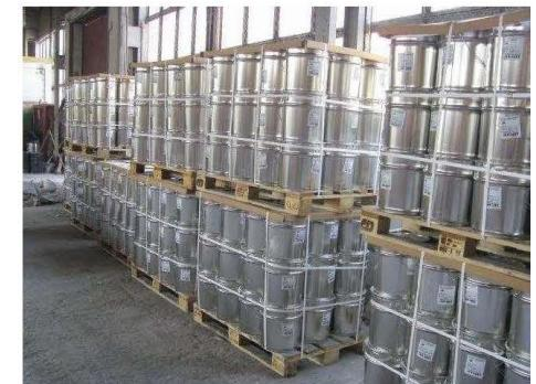
Рисунок 45. Стальные герметичные емкости с упакованным в них карбидом кальция, предварительно уложенным в заполняемые азотом полимерные пакеты.
