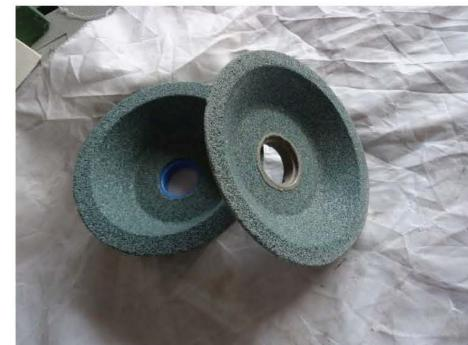
Рисунок 47. Сверхтвёрдые абразивные круги из карбида  $\text{B}_4\text{C}$
