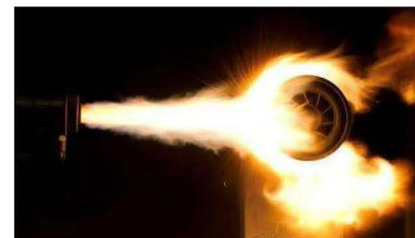
Рисунок 53. Напыление детонационно-термическим способом
