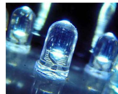
Рисунок 48. Карбид кремния, обладая свойствами полупроводника, широко используется в производстве светоизлучающих диодов
